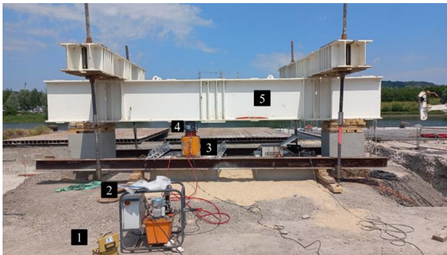
Figure 7. Système poutre/vérin pour l'application de la charge
