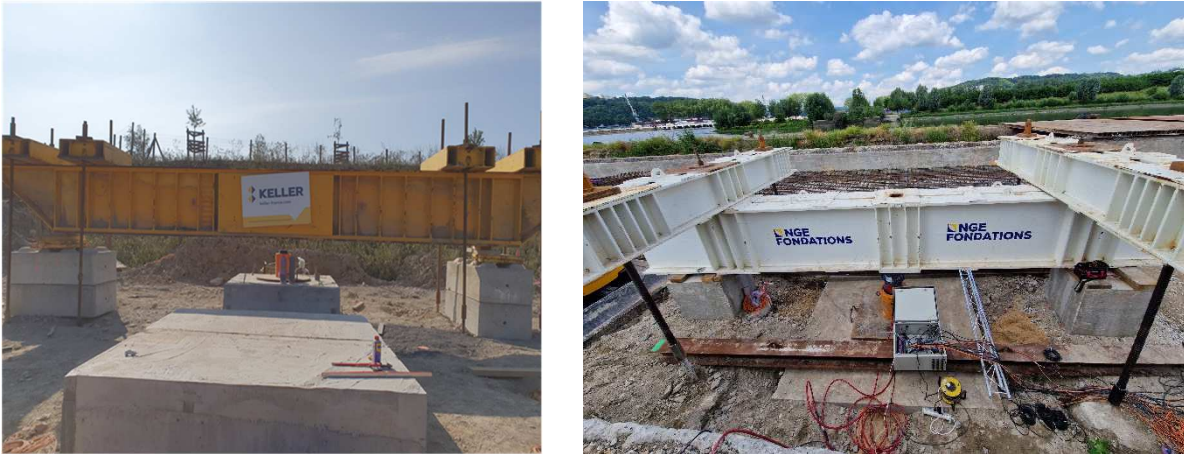
Figure 3. Moyens mis en œuvre pour étudier les semelles sur inclusions rigides (a) Plots expérimental de Dourges (b) Plot expérimental du port HAROPA de Rouen
