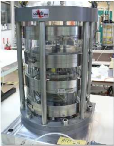
Figure 3. Colonne résonante du laboratoire GeoCoD du Cerema.
