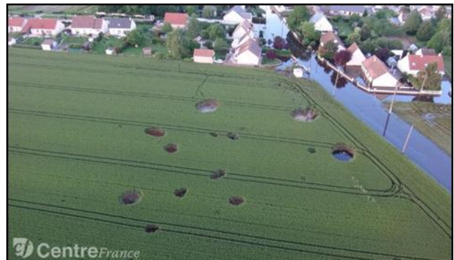
Effondrements d'une carrière souterraine à Gidy
