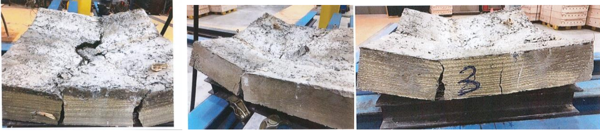
Figure 7 : type de rupture observées lors des essais absorption
