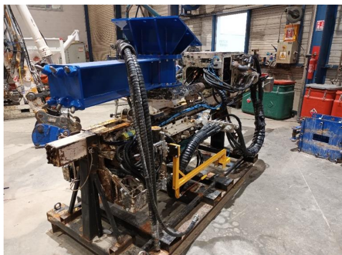
Figure 11 : utilisation de la pelle araignée pour la réalisation de certains forages, glissière lourde équipée sur la pelle de démolition
