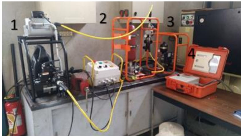
Figure 2. Composants du dispositif d'extraction dynamique : (1) pompe hydraulique, (2) accumulateur hydraulique, (3) électrovanne contrôlée, (4) automate programmable.
