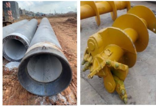
Figure 1. a) Embouts de pieu en acier - connexion soudée et b) Foret extensible (Hou et al., 2020)
