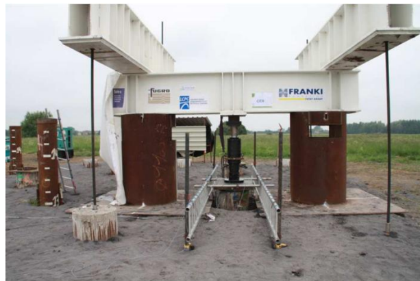
Figure 1 Photographie d'un essai de pieu en compression (Benzaria 2012)
