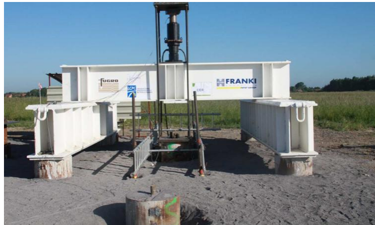
Figure 3 Photographie d'un essai de pieu en traction (Benzaria 2012)
