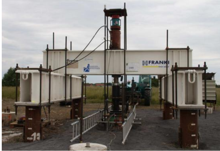
Figure 5 Photographie d'un essai de pieu alterné (Benzaria 2012)
