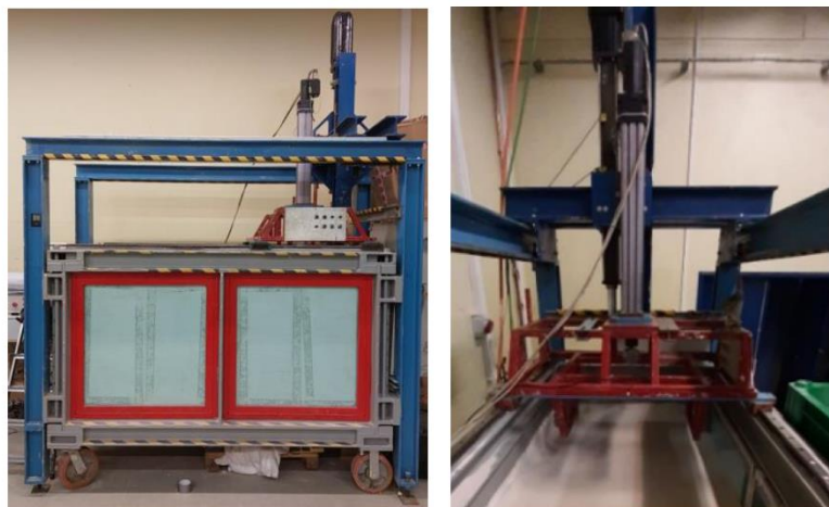
Figure 1 Vue de côté de la VisuCuve (gauche) et vérin de chargement (droite)
