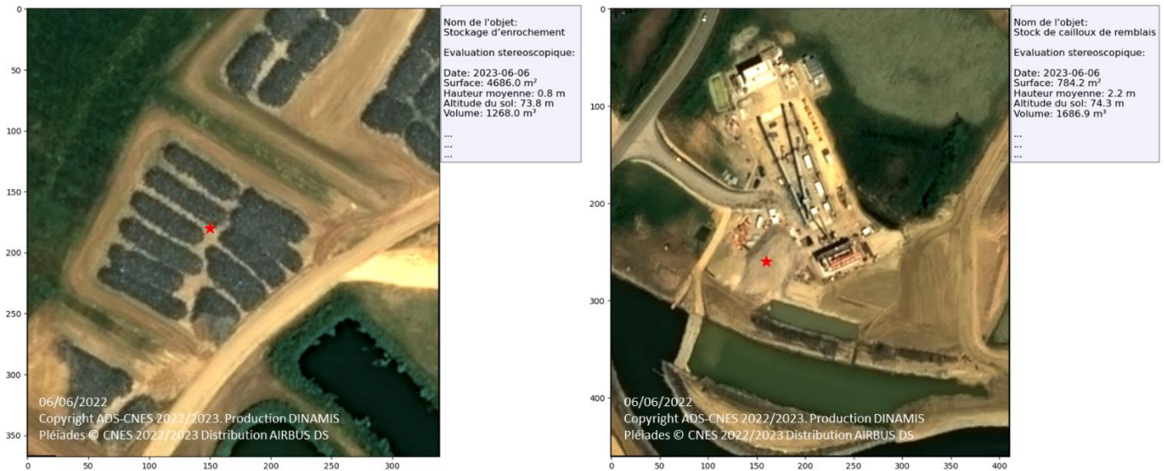
Figure 12. Calcul automatique des quantités de matériaux mis en œuvre sur le chantier
