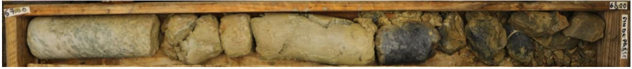
Figure 8. Dernières carottes du sondage SC16-5-20 avant interception du dyke
