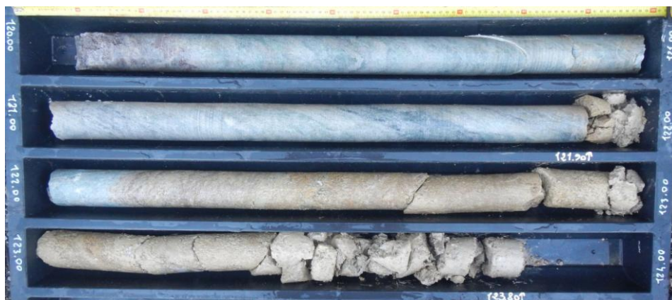
Figure 7. Dernières carottes du sondage SC19-4-20 avant interception du vide
