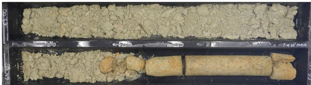
Figure 9. Sables argileux fluvio-glaciaires (FGb) et cargneule bréchique très altérée (t7-9) dans le sondage SC19-2-20.
