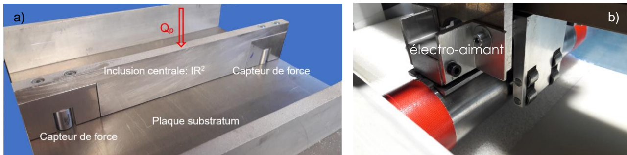
Figure 4 : a) IRs aluminium encastrées dans une plaque aluminium rigide de fond ; implantation des capteurs de force dans l'IR 2 centrale – Force Q_p en tête ; b) électro-aimant sous le portique.
