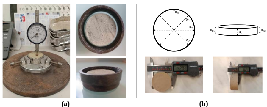
Figure 1. (a) Appareil de mesure du retrait linéaire, (b) mesure des dimensions de l'échantillon par un pied à coulisse
