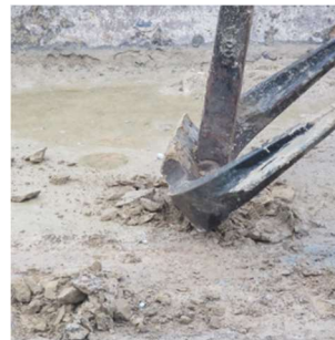
Figure 7. Performances après 1 an d'immersion par (a) essai JET et (b) chute d'ancre
