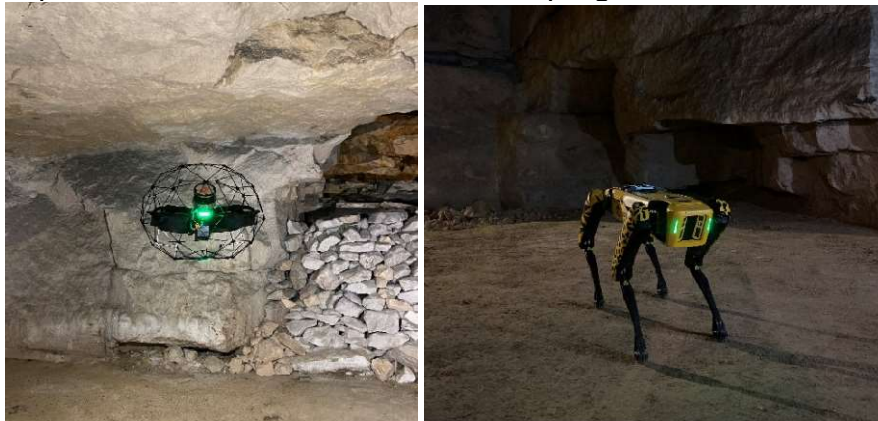
Figure 4. Exemples de drone-volant (à gauche) et de robot-chien (à droite) en souterrain
